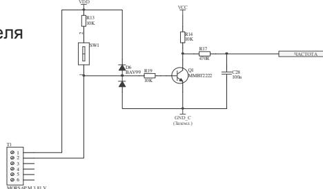
Схема соединений для частотного входа с сигналом напряжения
