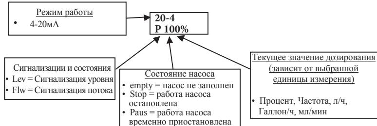
Параграф 4 – Пропорционально внешним импульсам (умножение)
